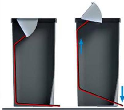
Sistema Basculante de accionamiento de la tapa
